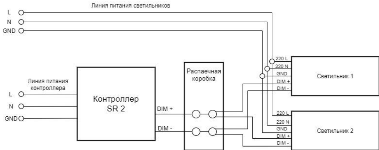
Рисунок 5.2. Схема подключения Контроллера SR 2 к светильникам (без пропуска питания)
